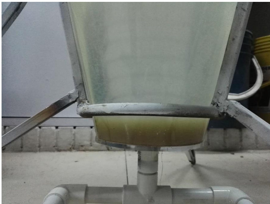
Imagen 5: Partículas de floc y lodo sedimentado
