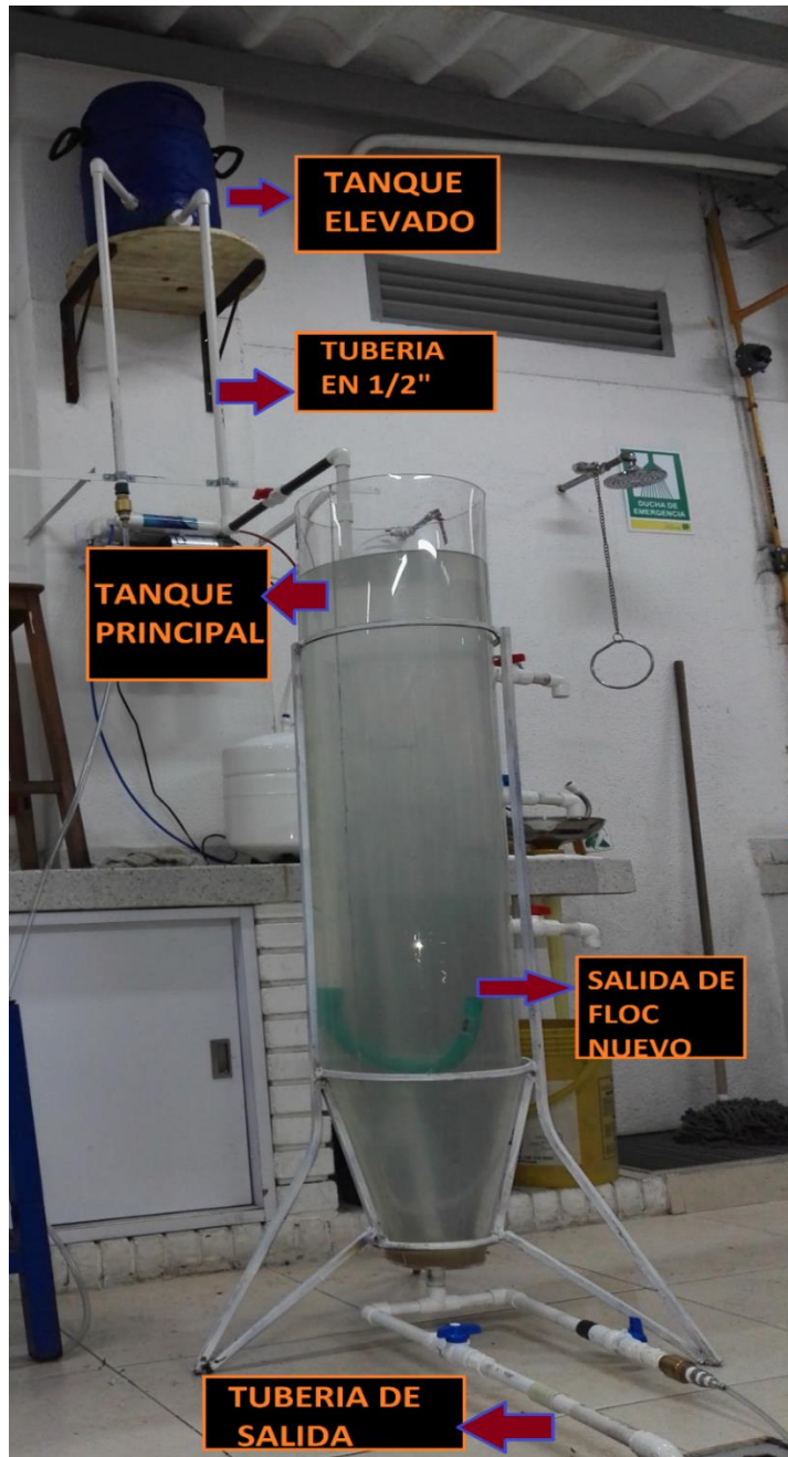
Imagen 3: Esquema y Montaje del Clarificador
