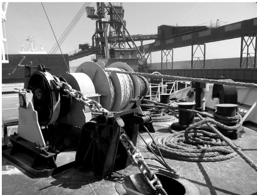
Figura 1. Guincho de amarre combinado (tambor de amarre e molinete para fondear)
