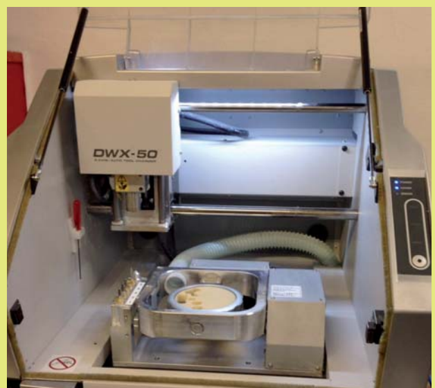
10. ábra: Roland DG DWX-50 fogászati marógépbe behelyezett PMMA tömb ideiglenes fogpótlás készítéséhez. A CAD/CAM technológiával készített PMMA ideiglenes fogpótlások előnye a hosszabb kihordási idő, hiszen ez a tökéletesen polimerizálódott anyag sokkal ellenállóbb, mint a hagyományos székkelletti ideiglenes anyagok
