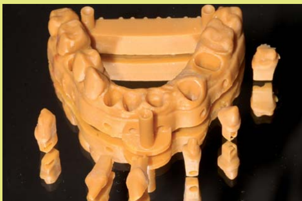
8. ábra: Nyomtatásos technikával – Objekt eljárással készített modell; UV fényre polimerizálódó anyagból a számítógép által meghatározott rétegenként felépített teljes fogív modell, kivethető mintacsonkokkal
