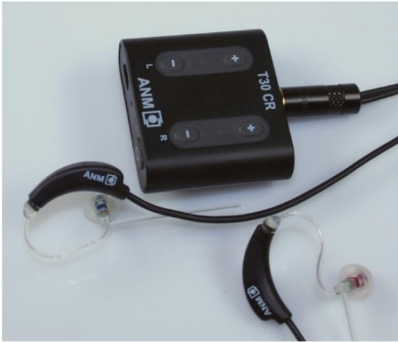
2. ábra Az akusztikus CR ® -neuromodulációs programozható stimulátor a hozzá csatlakozó nyitott fülillesztékekkel (az Adaptive Neuromodulation GmbH-től átvett fotó)
