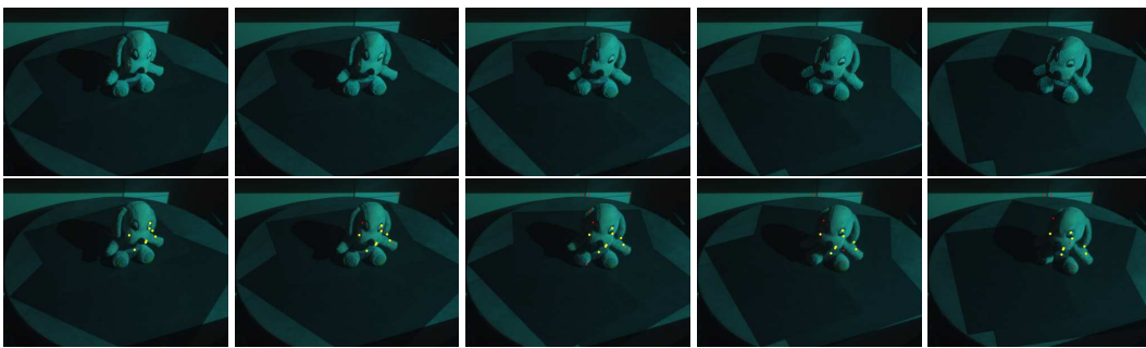
Figure 10: A GT követett pontok a 'Plüss Kutya' képsorozatokon. Felső sor: a pontokat egy egyenletes lépésközű négyzetrácsról választottuk ki. Alsó sor: a SIFT által kiválasztott pontok.
