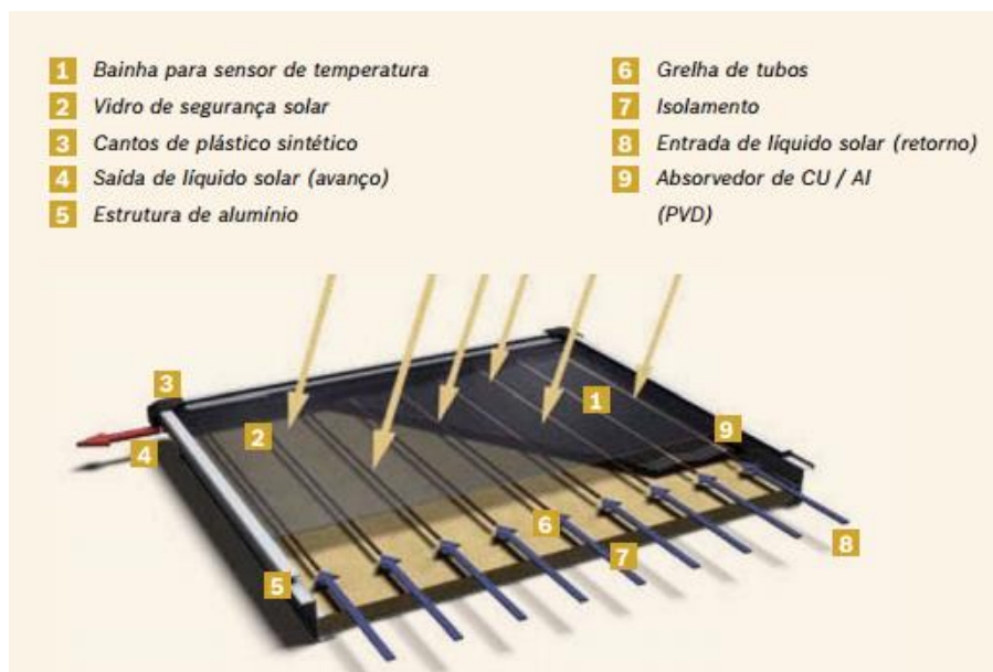
Figura 32: Constituição do coletor solar.
