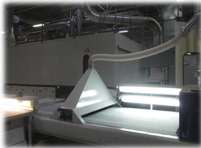
**Figura 42 - Barra Sopradora**
