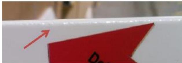
**Figura 22 - "Excesso de Tinta Cortante"**
