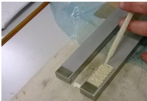
Figura 87 - Aplicação do adesivo Araldite® 2015 [1]
