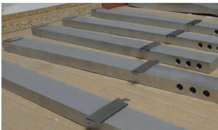
Figura 85 - Posicionamento dos calços nos substratos DCB [1]
