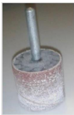
Figura 88 - Mó utilizada para remoção de excesso de adesivo nas faces laterais dos provetes [1]
