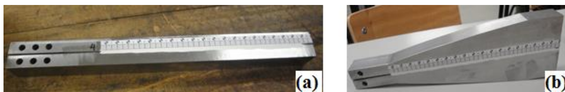
Figura 90 - Provetes preparados: DCB (a); TDCB (b) [1]
