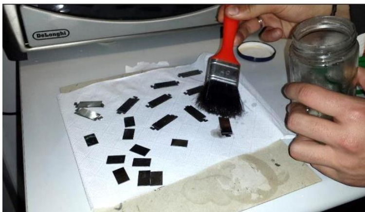
Figura 84 - Aplicação de desmoldante nos espaçadores [1]
