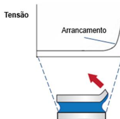
Figura 10 - Esforço de arrancamento e respetiva distribuição de tensão [11]
