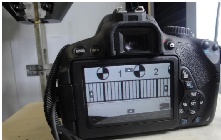
Figura 94 - Máquina fotográfica utilizada para a medição do comprimento de fenda [1]
