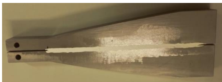
Figura 89 - Provete TDCB com corretor aplicado na face lateral [1]
