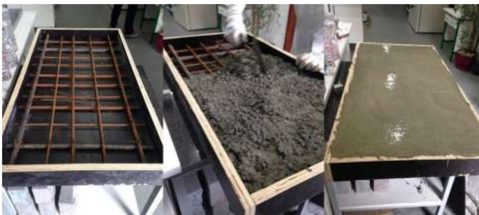
Figura 4.3 – Processo de execução da primeira placa de ensaio
