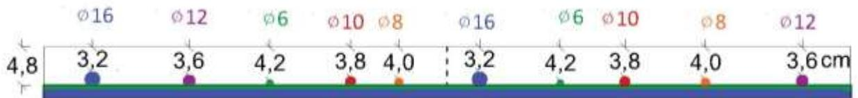
Figura 4.5 – Esquema, em corte A, das armaduras das placas de betão produzida em laboratório
