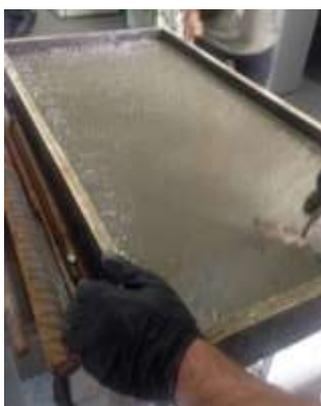
Figura 4.18 – Betonagem da placa sem armadura
