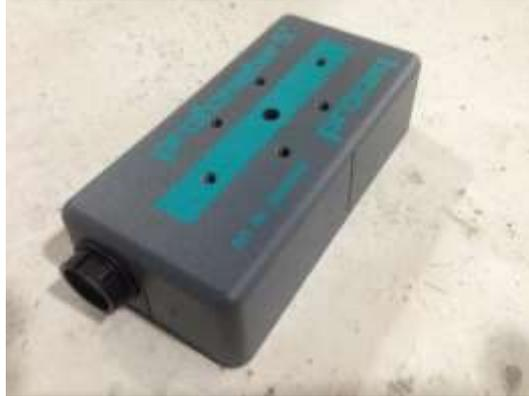
Figura 5.3 – Sonda universal – PROFOMETER 5+
