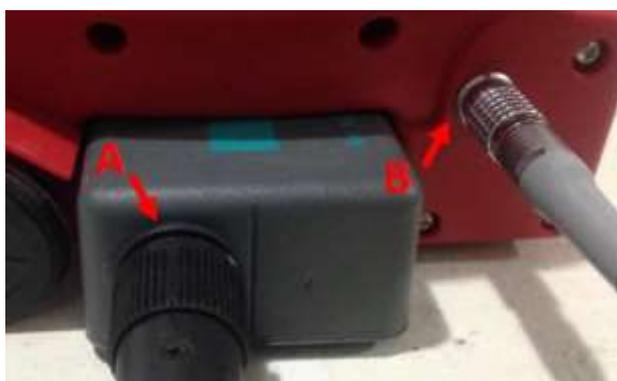
Figura 5.6 – Legenda de cabos conectáveis – sonda universal e *ScanCar*
