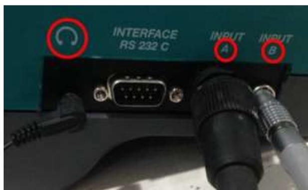
Figura 5.5 – Legenda de cabos conectáveis – módulo central
