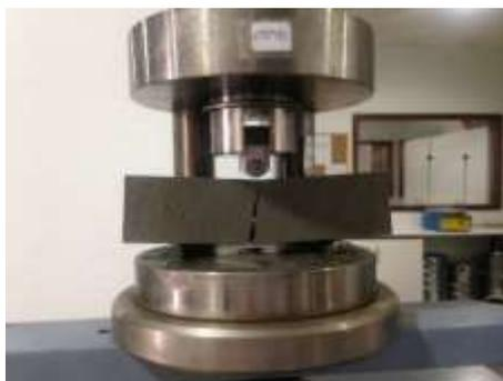
Figura 3.7 – Ensaio de resistência à flexão
