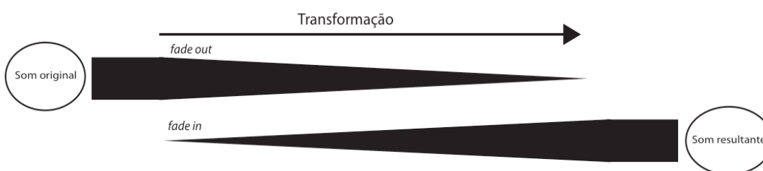
Fig. 11 - Esquema representativo do processo de cross-fade
