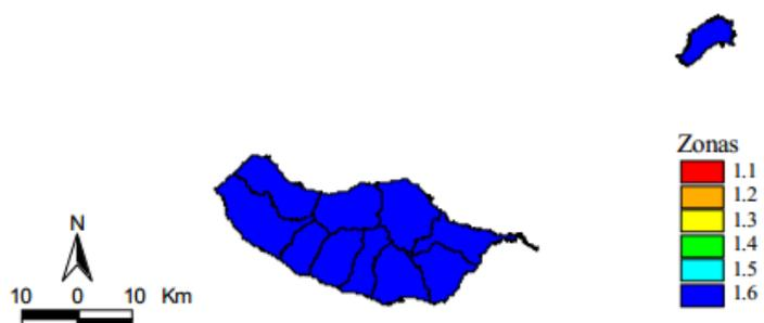
**Figura 4.6** Zonamento sísmico no Arquipélago da Madeira ( NP EN 1998-1, Figura NA.II).
