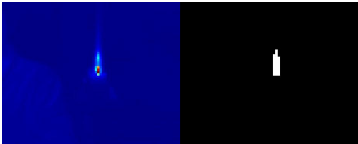
Figura 3.8 - Imagem termográfica (à esquerda) e imagem binária (à direita) com ponto de referência igual a 9000 e 0.3m de distância.
