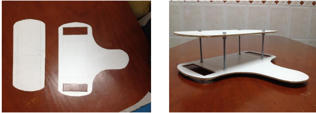
Figura 2.13 - Placas de madeira contraplacada utilizadas na construção do protótipo.
