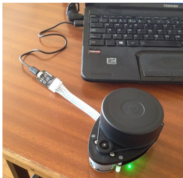
Figura 3.14 Ligação entre RPLIDAR 360° e o PC.
