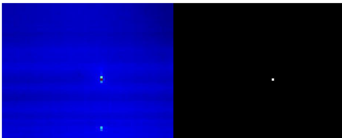
Figura 3.11 - Imagem termográfica (à esquerda) e imagem binária (à direita) com ponto de referência igual a 9000 e 3m de distância.
