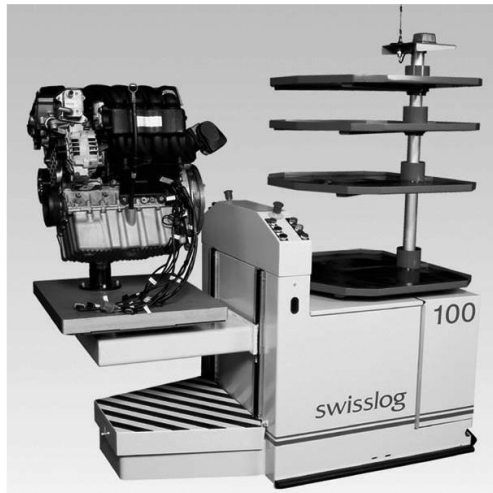
Figura 1.3 - AGV criado pela empresa SWISSLOG usado para transportar blocos de motor de um posto de montagem para outro, sendo guiado por um fio elétrico instalado no chão. Fonte: (Siegwart, Nourbakhsh, & Scaramuzza, 2011)
