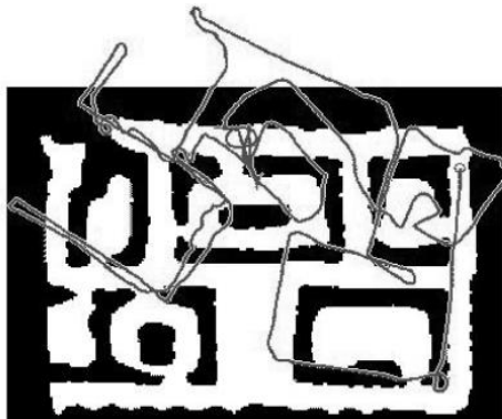
Figura 2.20 - Erro acumulativo de localização de um robô decorrente de pequenos erros de odometria causados pelo escorregamento das rodas. Fonte: (Thrun, 2002)
