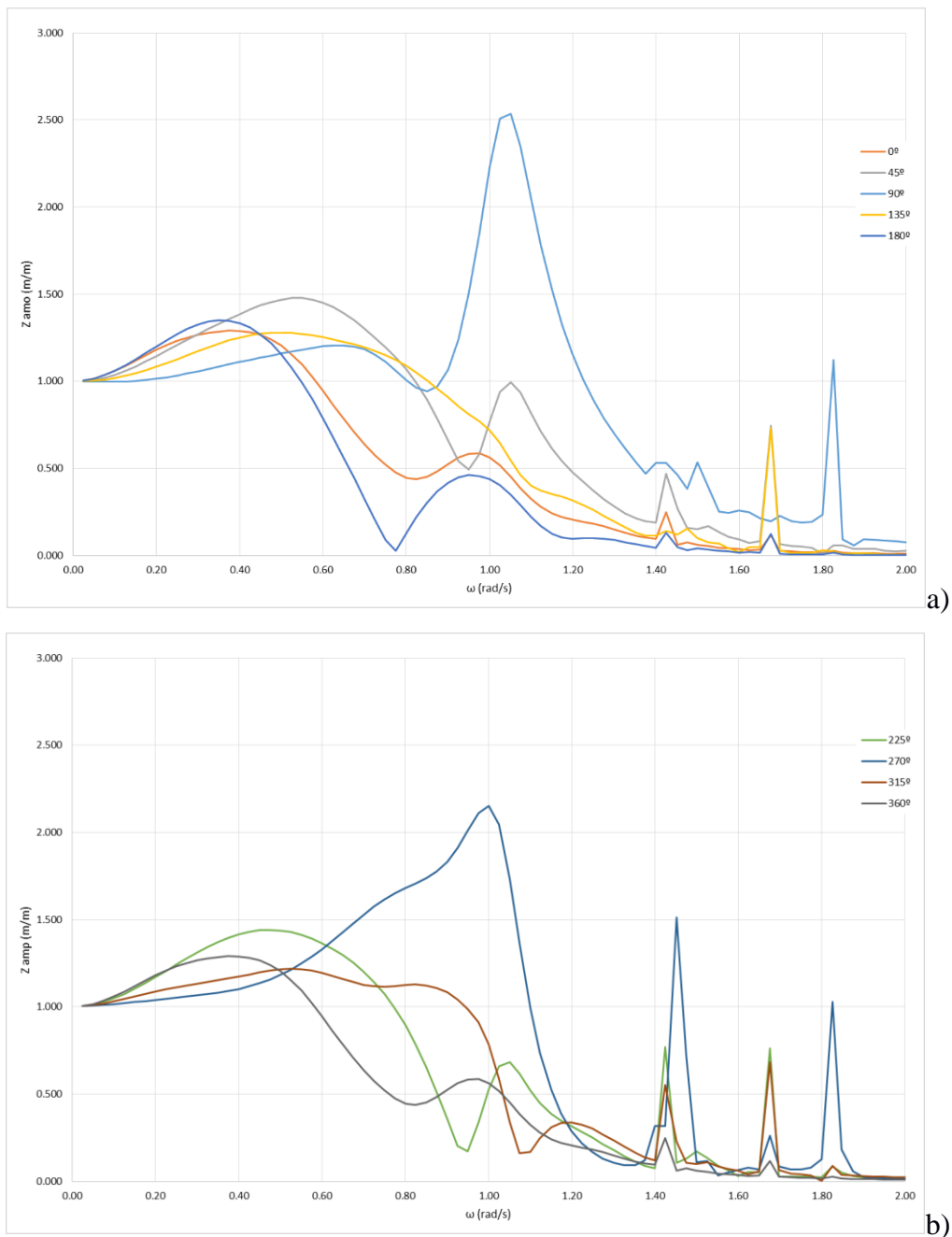
Figura 4.3 – Influência na amplitude do movimento vertical para o ponto A do ângulo de incidência das ondas com o navio, quando este está sobre uma zona de profundidade 10.4 m. a) \beta a variar entre 0^\circ e 180^\circ . b) \beta a variar entre 225^\circ e 360^\circ .
