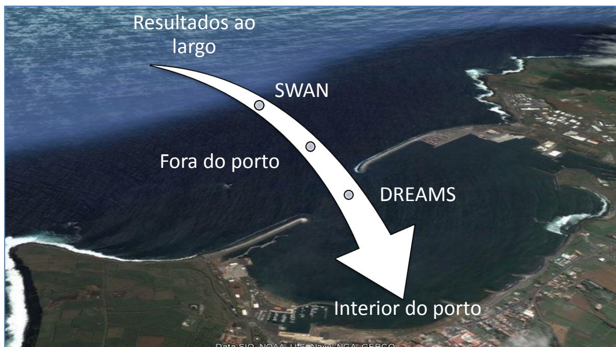
Figura 2.2 - Propagação das ondas desde o largo até ao interior de um porto.
