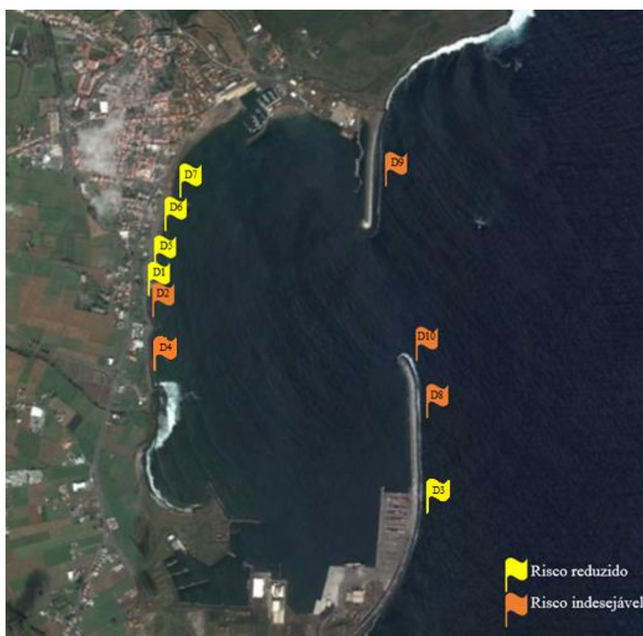
Figura 5.43 – Representação gráfica do grau de risco de galgamento determinado pela metodologia simples (adaptado de Google Earth).
