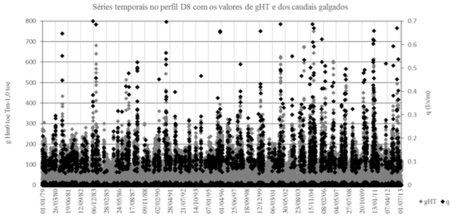
Figura 5.33 – Série temporal dos valores de gHm0Tm-1,0 e dos caudais médios galgados, q, no ponto D8, obtidos com a ferramenta NN_OVERTOPPING2.
