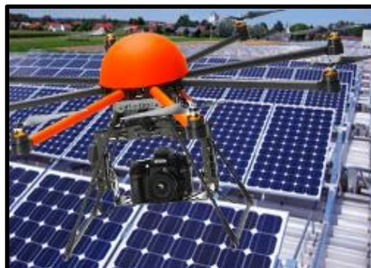
**Figura 3.25** – Medição termográfica aérea recorrendo a *drones* [92].
