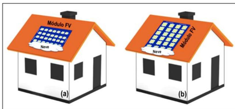
**Figura 3.22** – Módulo fotovoltaico sombreado devido a deposição de uma camada de neve: (a) módulo na posição horizontal; (b) módulo na posição vertical [67].
