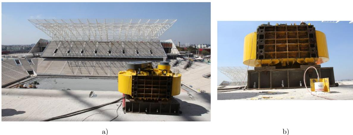
**Figura 3.1** - Arena Corinthians: a) o setor de arquibancada do Arena Corinthians; e b) vibrador.
