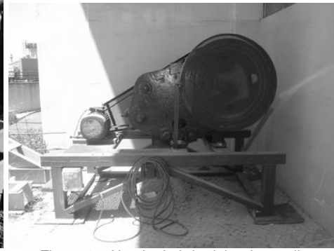
Figura 3 - Alçado da britadeira de maxilas usada
