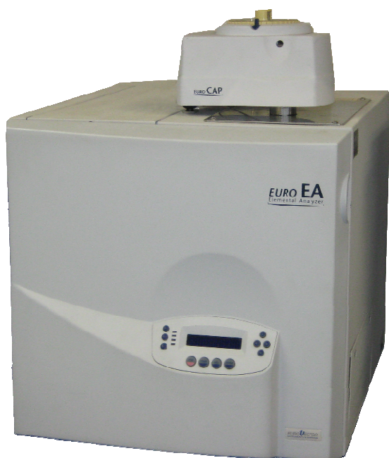
Fig. 2.3. Euro EA 3000 CHNS-elemental analyser.
