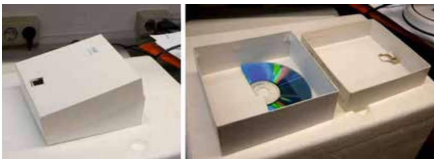
Figura 5. Espectroscopi manual fet amb una capsa i un disc compacte.
