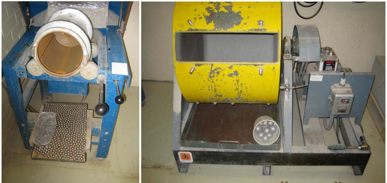
Kuva 15. Kuulamylykokeen testauslaite (vasen) ja Los Angeles-kokeen testauslaite. Kuulamylykokessa kiviainesnäytettä kulutetaan veden ja pienien teräskuulien avulla, kun taas Los Angeles –kokeessa ei käytetä vettä ja teräskuulat on selvästi kookkaampia. Kuvat Matti Mertamo.
