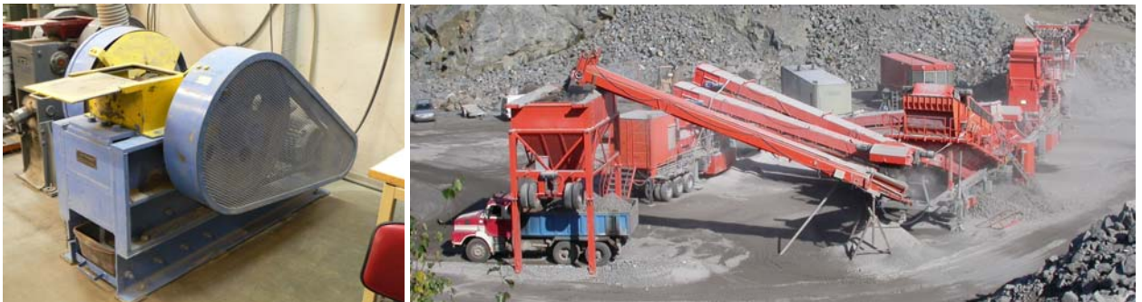
Kuva 14. Laboratoriomurskaimella ja tuotantomurskaimella tuotettujen murskeiden ominaisuudet vaihtelevat.
