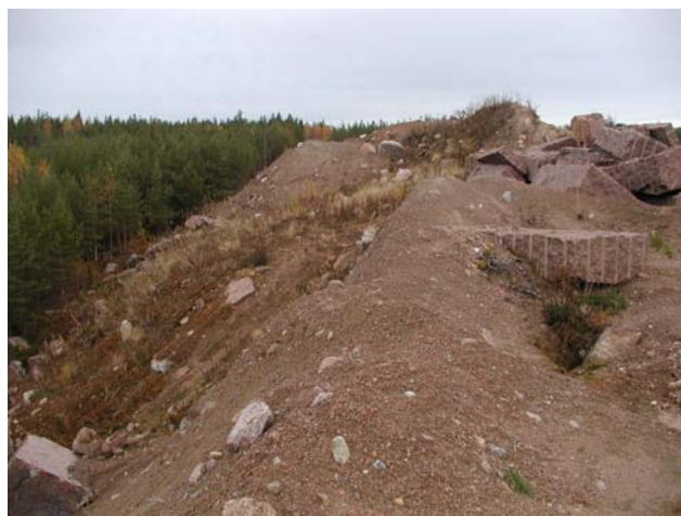
Kuva 10. Pintamaiden sekoittuminen vaikeuttaa sivukivien hyötykäyttöön ottamista.
