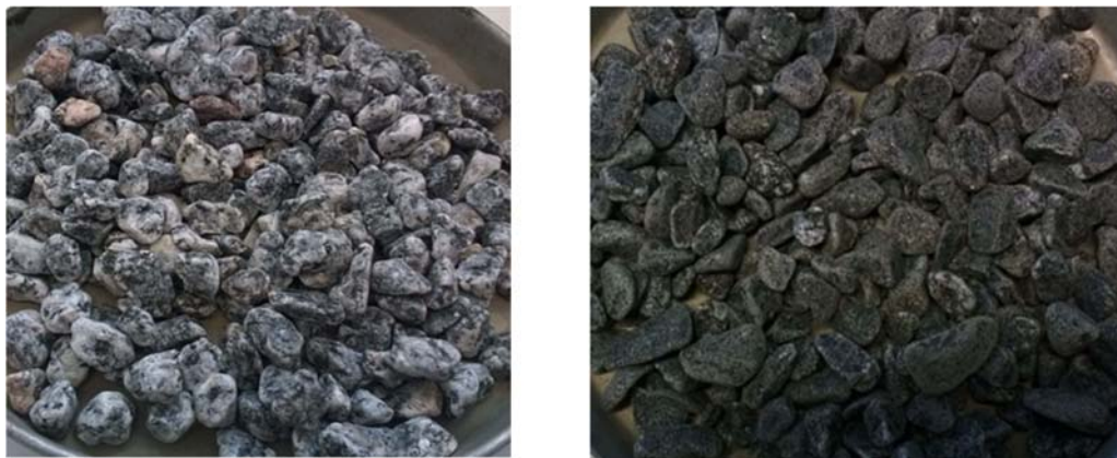
Kuva 5. Kiviaineksesta TC erotettujen graniittisen osan (vasemmalla) ja liuskeisen (oikealla) osan kuulamylynäytteet.
