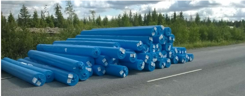
Kuva 38. Suodatinkankaita työmaan varastossa.
