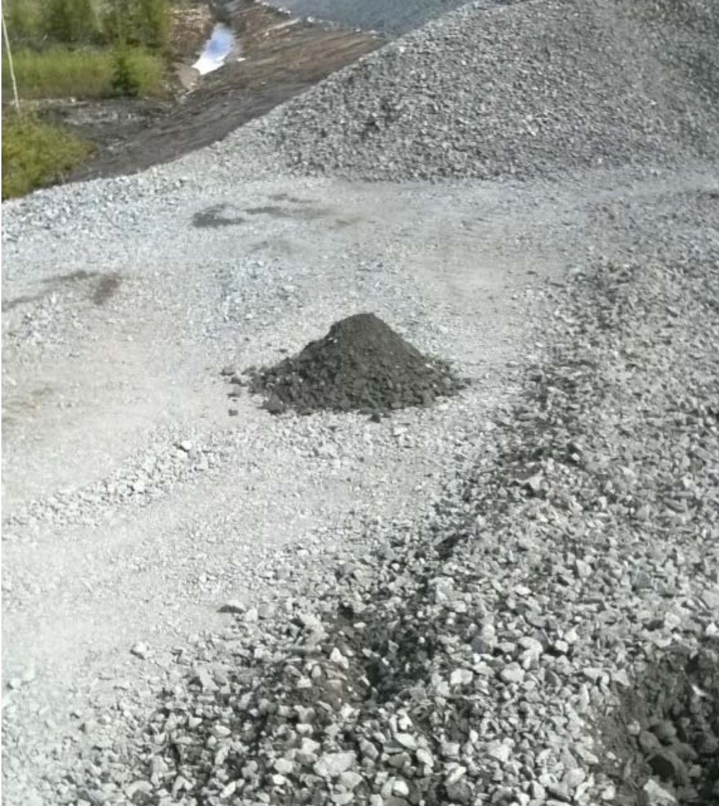
Kuva 2. Levitetystä materiaalista otettu näytteenottostandardin (SFS-EN 932-1) mukainen näyte.
