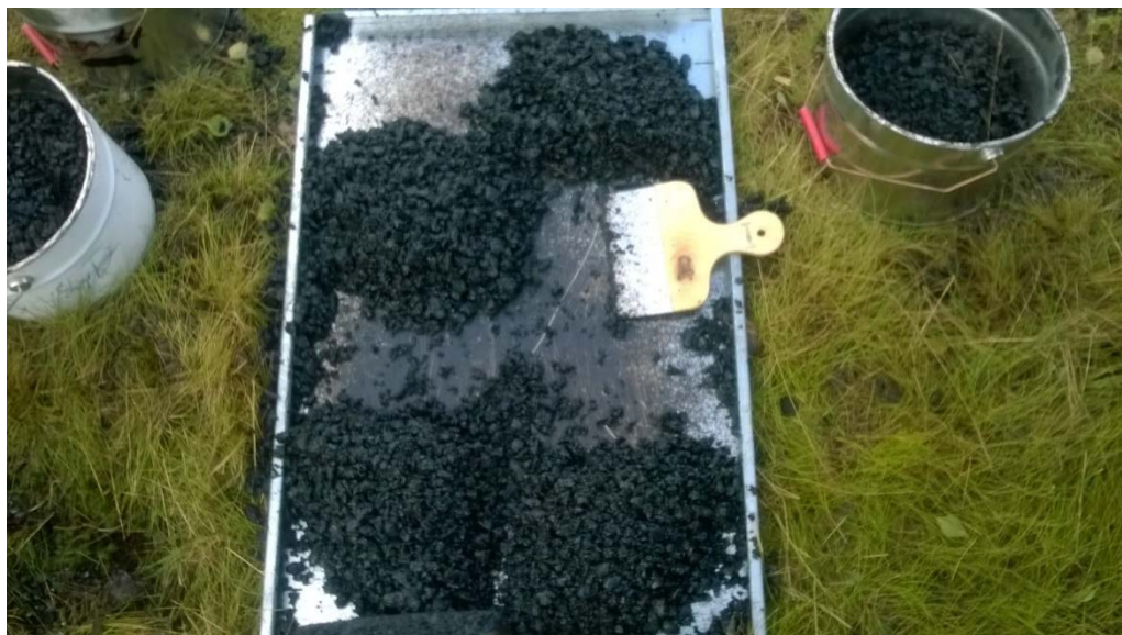
Kuva 7. Asfalttimassanäytteen jakamista työmaalla teräslevyn päällä.
