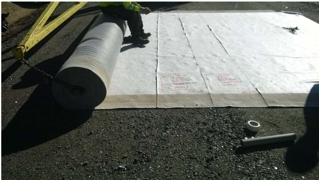
Kuva 53. Bentoniittimattonäytteiden leikkaaminen täydestä rullasta. Kuvassa näkyvät näytteeseen tehtävät merkinnät.
