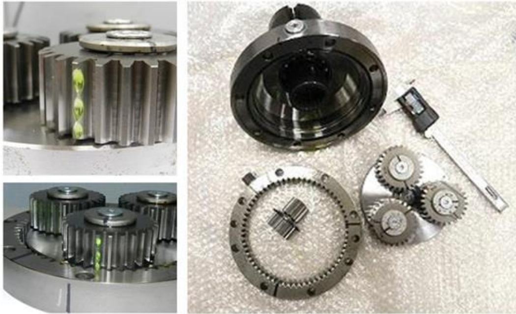
Figure 8.1 Planet gear tooth fault F1
