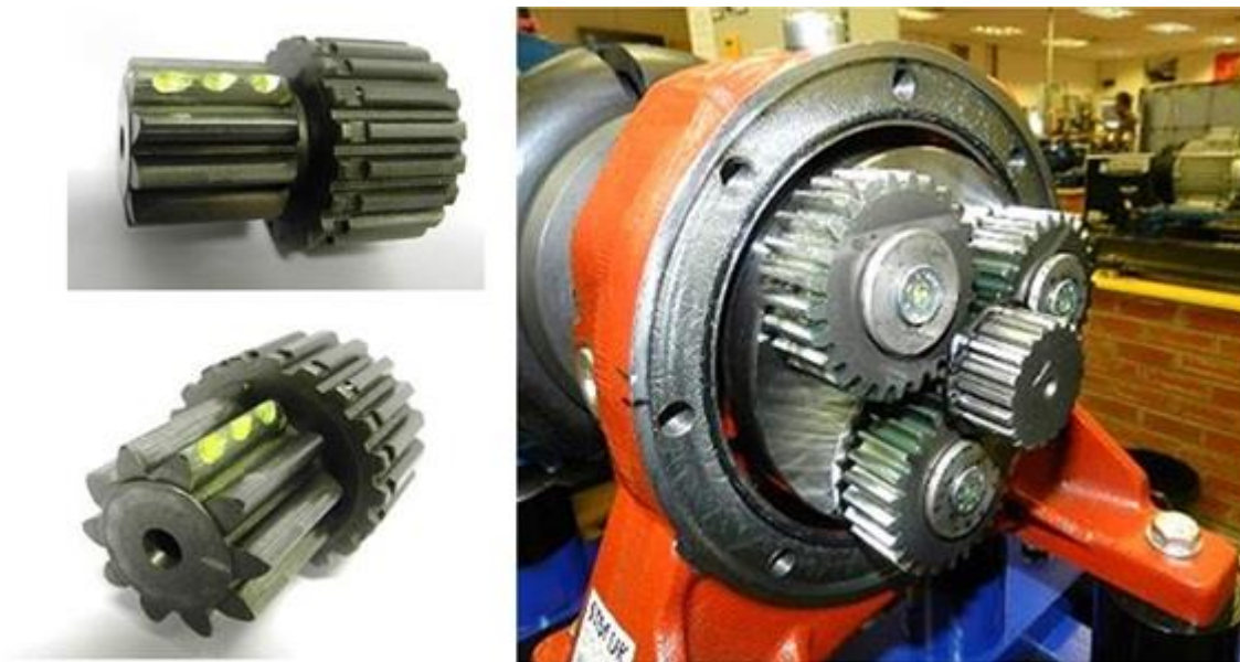
Figure 7.4 Sun gear tooth fault F1
