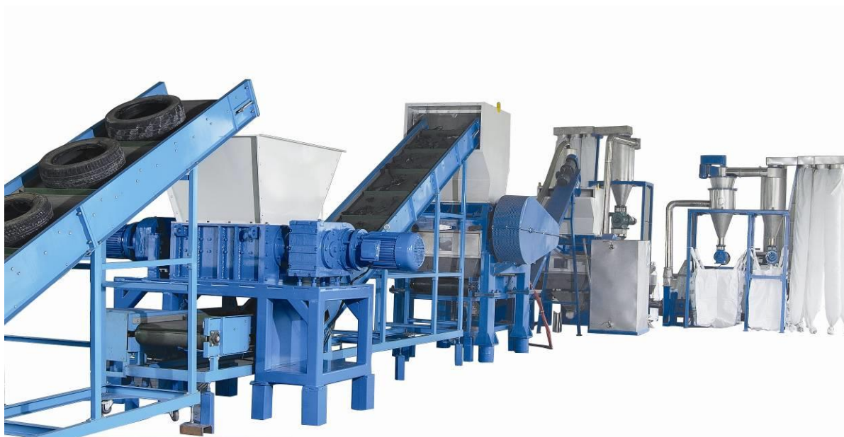
Figura 14. Planta con capacidad de 800 kilos / hora
