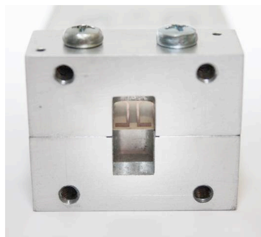
Рис. 3.21 – Фото двотактного генератора з виходом на третій гармоніці на основі МСЛ резонатора.
