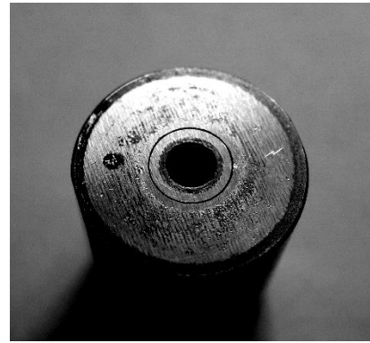
Рис. 4.32. Поверхня повзуна рухомої системи приводу УФ 098190 з втулкою зі сталі ХВГ після 100000 циклів спрацювання
