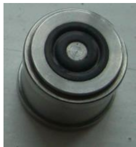
Рис. 4.11. Канавка на гумовій поверхні при виробітку ущільнення на 30% ресурсу
