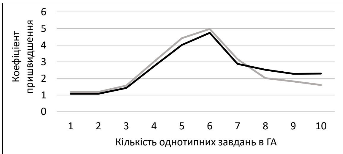
Рис. 3.10. Дослідження показників прискорення: — — адаптивне відображення задач на реконфігуровне обчислювальне середовище; — — оптимізація відображення задач
