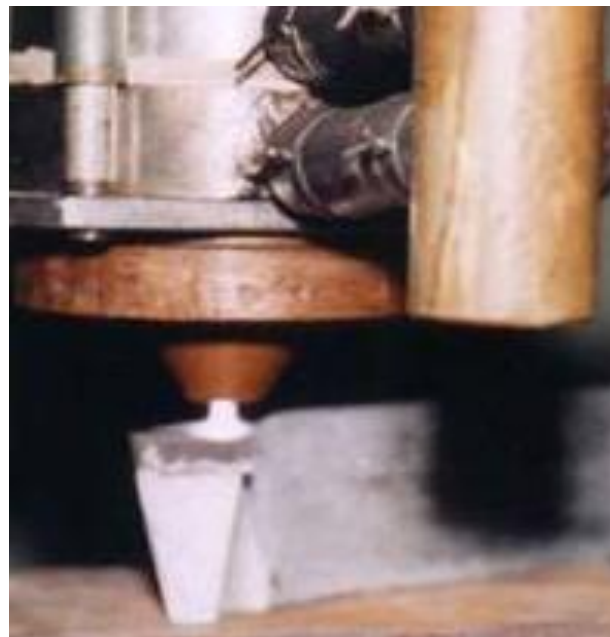
Рис. 2.2. Установка для плазменного упрочнения инструмента (а); обработка твердосплавных резцов (б)
