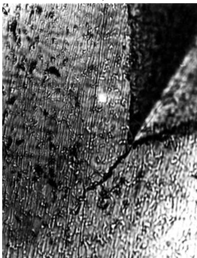
Рис. 4.2. Характер развития трещин при нагружении индентором в твердых сплавах: а, б – ВК6; а – исходное состояние; б – после плазменной обработки без оплавления; \times 600
