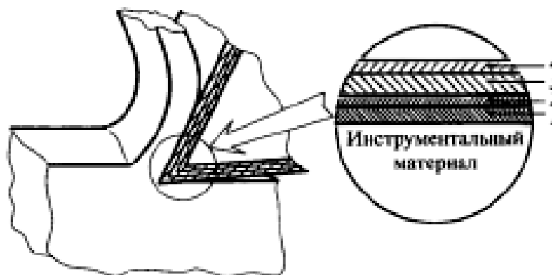
Рис. 1.8. Схема построения покрытия композиционно-многослойного типа [3]
