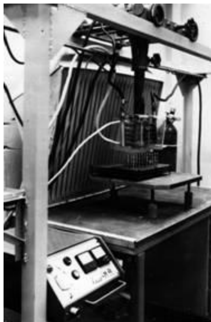
Рис. 2.2. Установка для плазменного упрочнения инструмента (а); обработка твердосплавных резцов (б)
