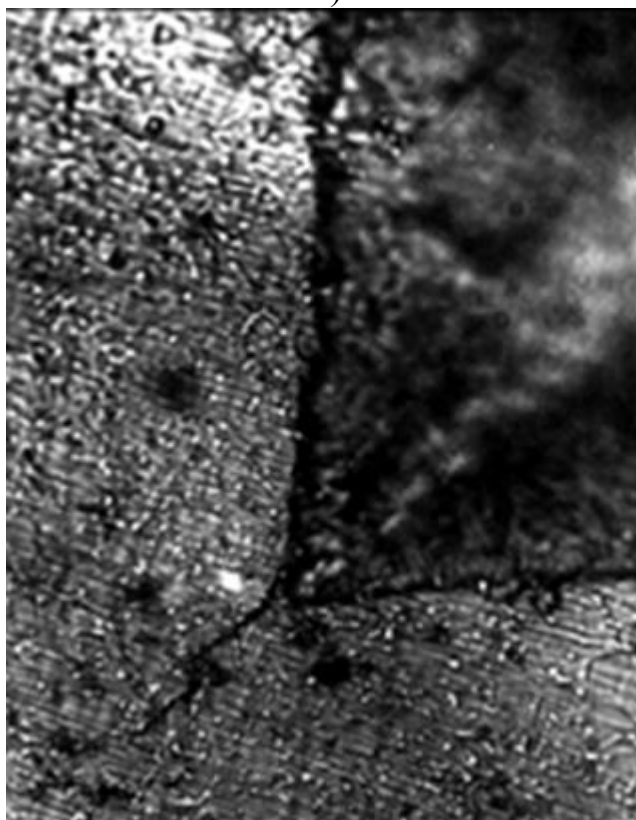
Рис. 4.2. (продолжение): в, г – ВК15; в – исходное состояние; г – после плазменной обработки без оплавления; \times 600
