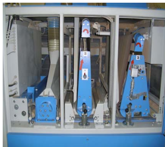
Рис. 2. Базовая конфигурация фрезерно-шлифовального узла
