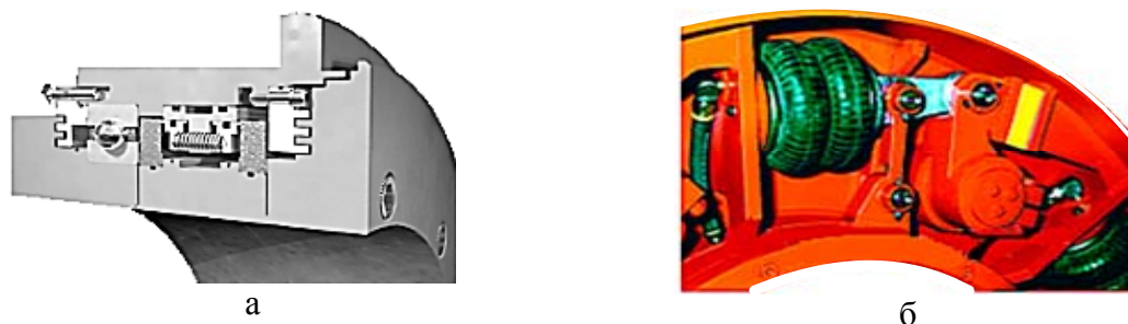
Рис. 2. Воздухонепроницаемый ротор с системами «Air-Ten» [2-4]: а – внутреннее кольцо ротора с воздушными камерами; б – пневмоприжим короснимателя станка «Nicholson»
