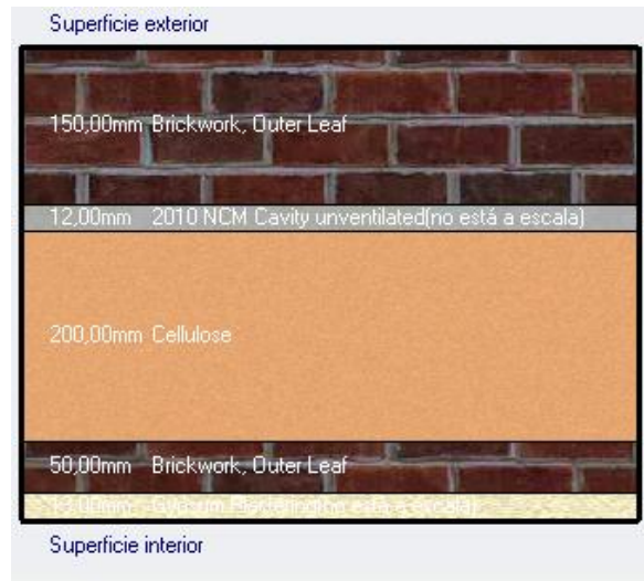
II-lustració 53: Mur de les parts exteriors.
