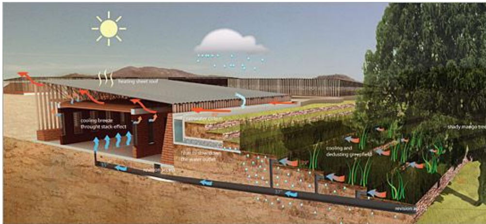
Il·lustració 24: Refrigeració utilitzant la inèrcia tèrmica de la vegetació i el soterrament. Font:(Gramas, 2014)
