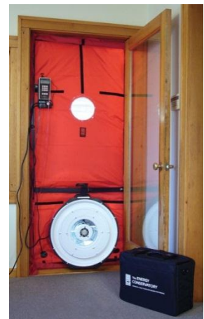
Il·lustració 39: Test de blower door. Font: (Certificados Energeticos, n.d.)
