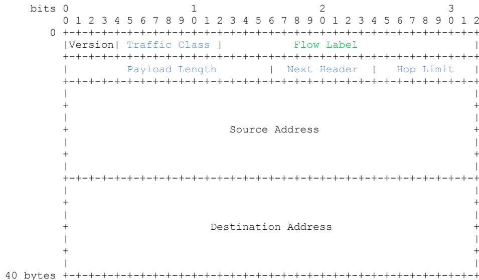
Fig. 1.3 Format de la capçalera IPv6 [3]
