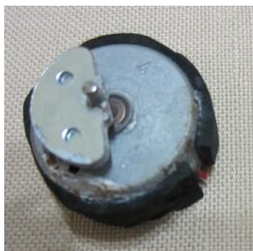
Fig. 4.16 Motor de vibración con una rueda excéntrica
