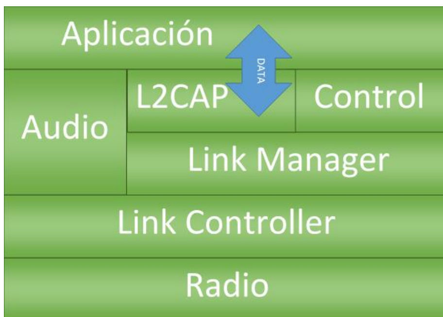
Fig. 6.6 Capas del protocolo Bluetooth usando L2CAP (fuente propia)
