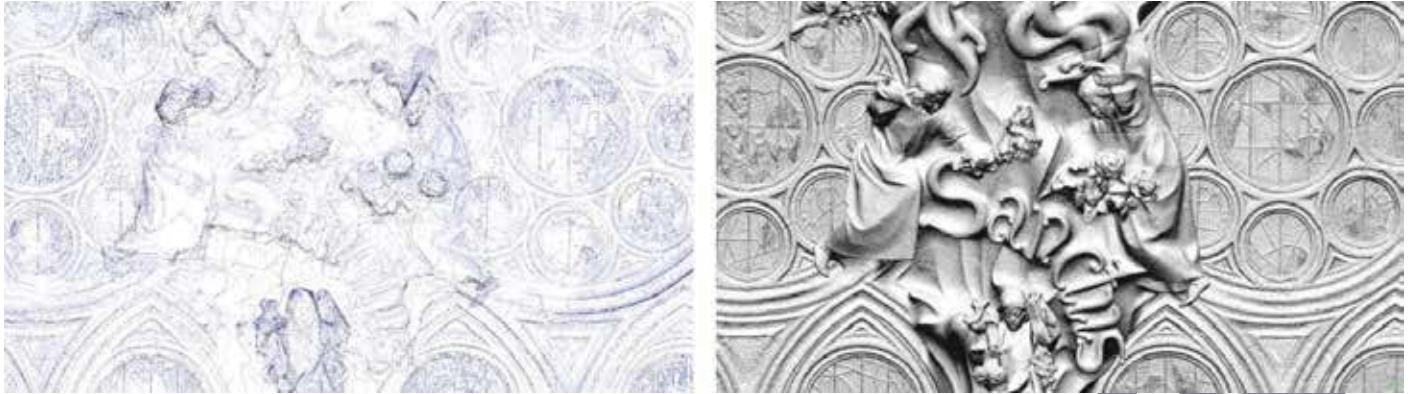
Ilustración 4. Filtrado de continuidad de la superficie. Izquierda ruido, derecha modelo de nube de puntos final
