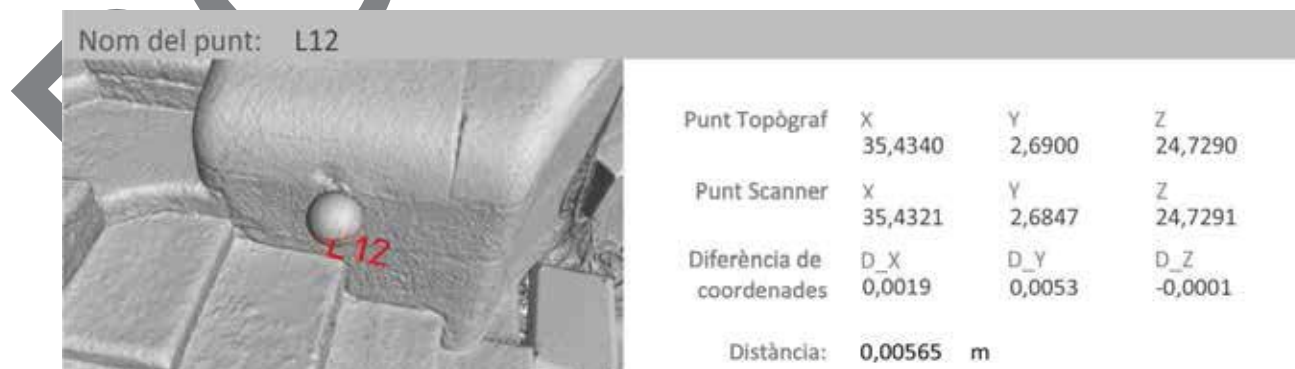
Ilustración 12. Control de calidad mediante la detección de esferas y levantamiento topográfico
