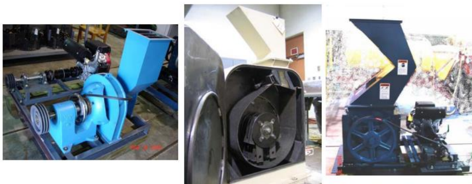
Il·lustració 5: Instruments utilitzats habitualment per efectuar la disminució de mida: molí de disc, molí de martells i molí de fulles (7)
