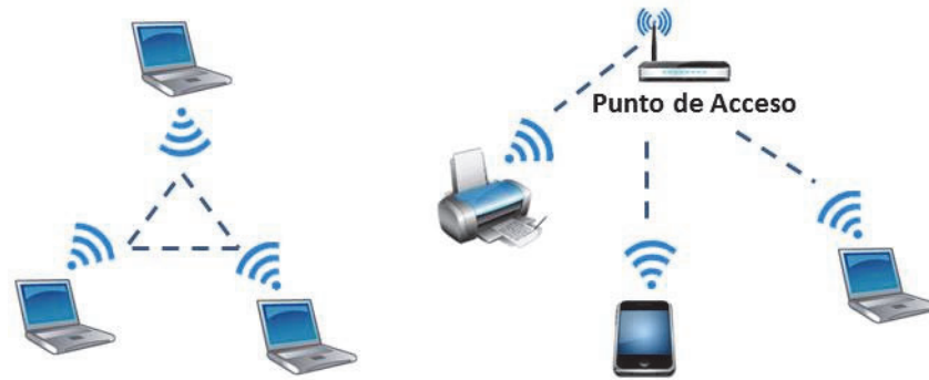
Figure 1.9 Con junto de servicios básicos (BSS) e Independiente (IBSS).
