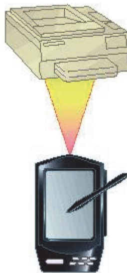
Fig. 2 . Comunicación IrDA entre una PDA y una impresora (punto a punto)
