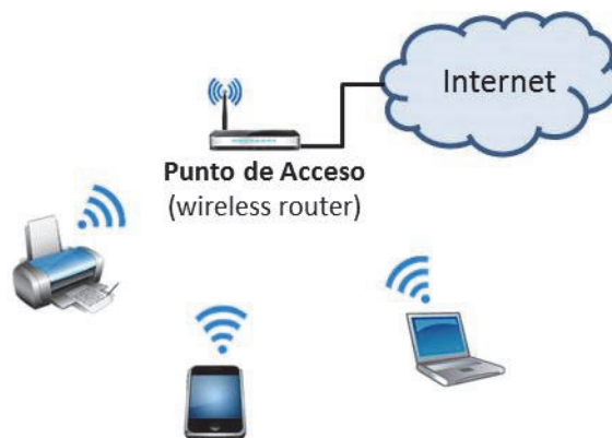
Figure 1.6 Esquema de una WLAN en el hogar
