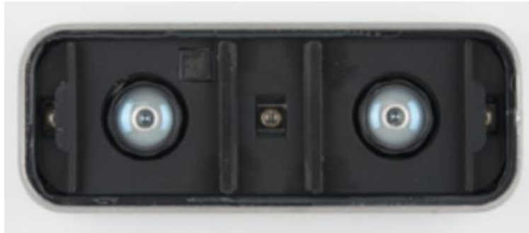
Fig. 4.10: LEDs incorporats al dispositiu Leap Motion
