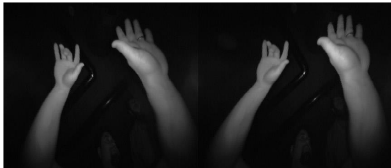
Fig. 4.18: Les dos imatges que arriben al driver del Leap Motion
