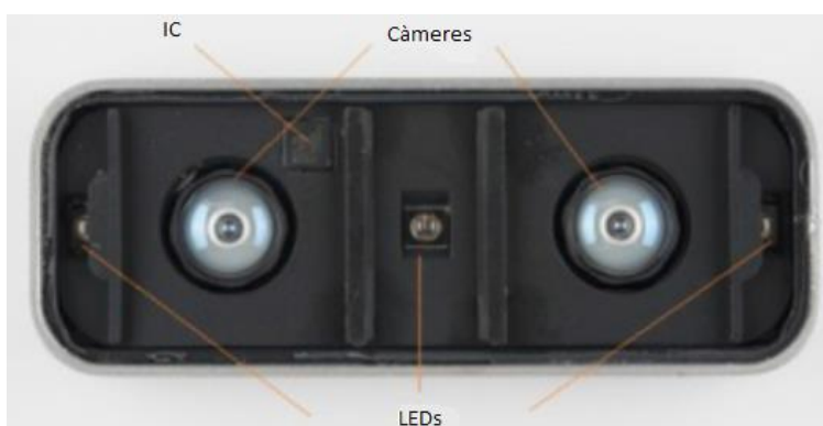
Fig. 4.9: Parts del dispositiu Leap Motion
