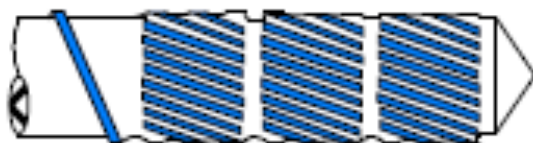
Fig. 2.15. Detall de la zona d'homogenització del cargol extrusor
