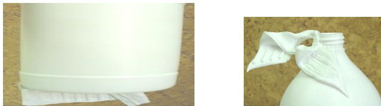
Fig. 3.3. Exemples de productes amb rebaves
