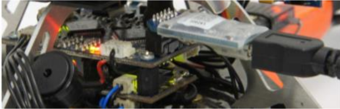
Figura 5-2 JTAG connectat al HL del Hummingbird (27)
