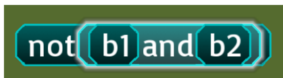
Figura 8: El bloque de tipo booleano 'and' tiene como parent el bloque 'not'
