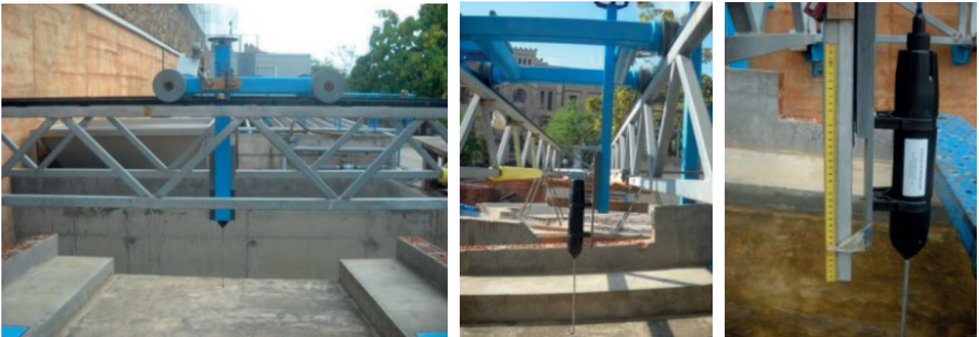
Figura 4 | Instalación del Vectrino en la plataforma de ensayos.
