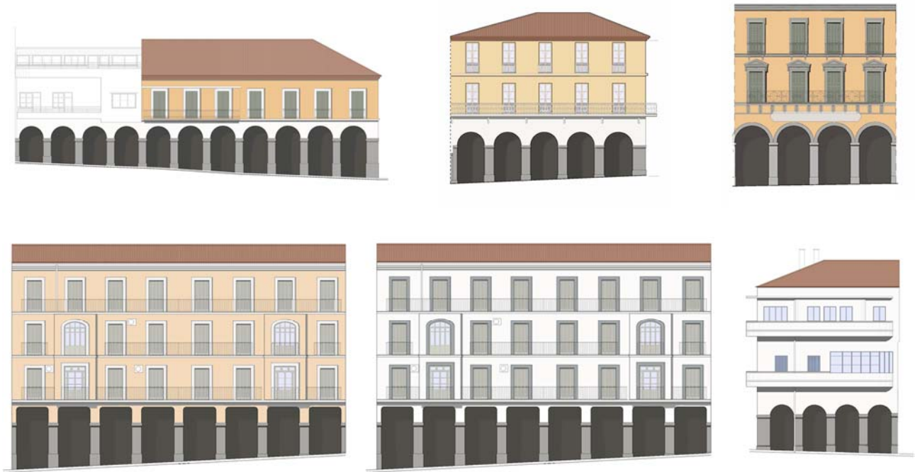
Ilustración 7 Hipótesis cromáticas de las fachadas según determinación de colores en muestras extraídas
