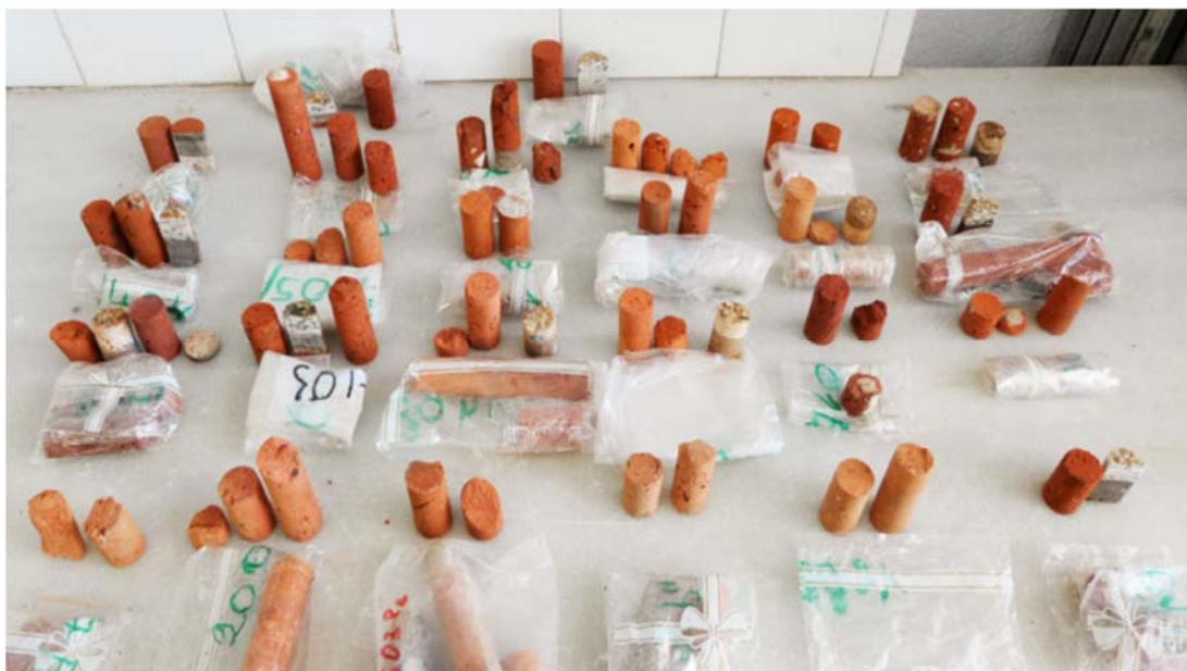
Figura 4 Catalogación de muestras de materiales cerámicos extraídas de los muros portantes
