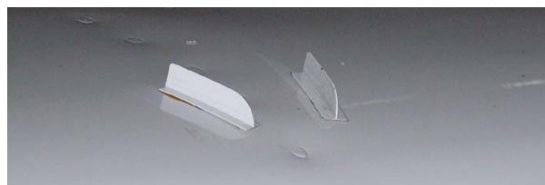
Fig. 3-13 Generador de vórtices de una Cessna 182 de [AeroDynamics, 2003]
