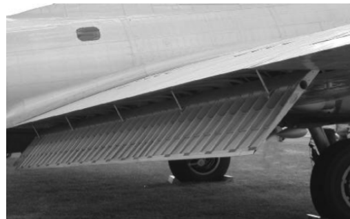
Fig. 3-3 Flap de intradós de un Boeing B-17 de [Anderson and Eberhardt, 2001]
