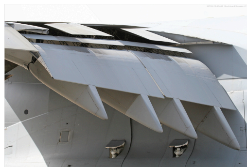
Fig. 3-5 Flap con ranura simple de un Boeing C-17A de [USAF and AMC, 2008]
