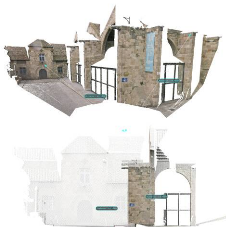
Figura 3.4: Diferencia entre resolución y escala en un modelo de nube de puntos.
