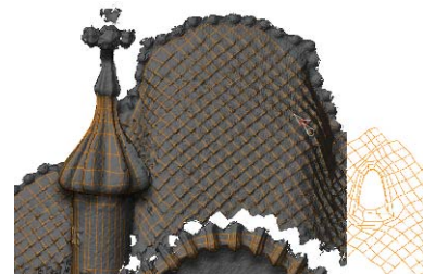
Figura 4.48: Malla de alta resolución y trama de la retopología
