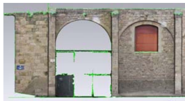
Figura: Retopología sin proyección con la textura de la nube de puntos,
