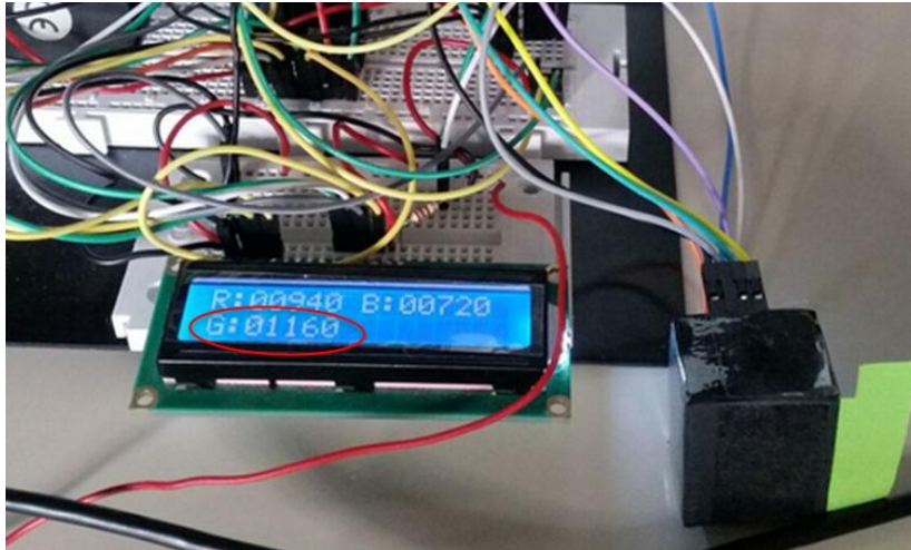
Fig. 8.13. Circuito y valor de la frecuencia para la detección del color verde
