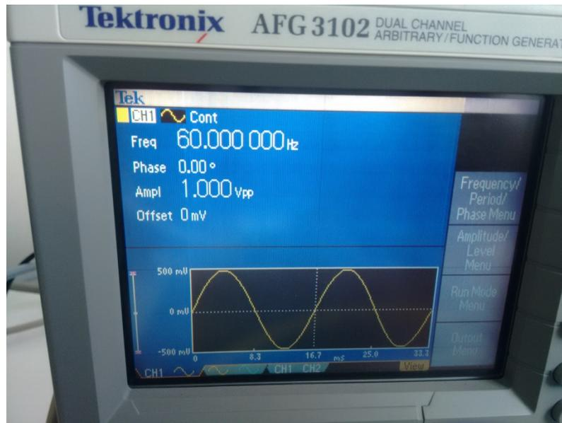
**Figura 43:** Generador de funciones con los valores introducidos en el panel frontal.
