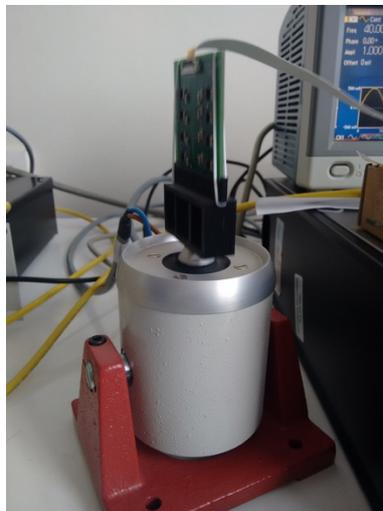
*Figura 3: Vibrador de LDS modelo V201.*
