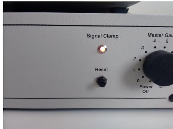
**Figura 42:** Amplificador en estado de seguridad (Primer encendido)
