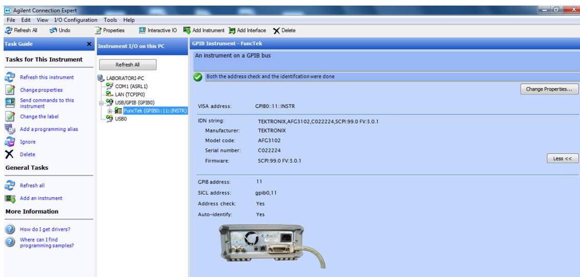
**Figura 39:** Adaptador y generador de funciones funcionando sin errores en Agilent
