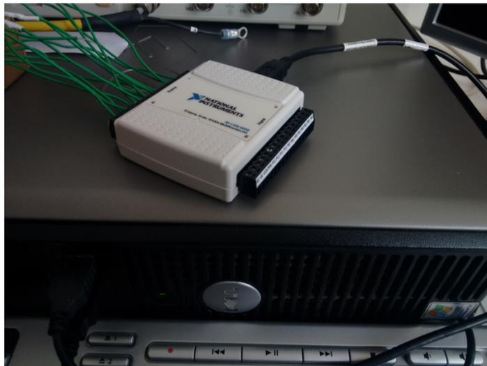
**Figura 7:** Módulo de adquisición National Instruments USB 6008
