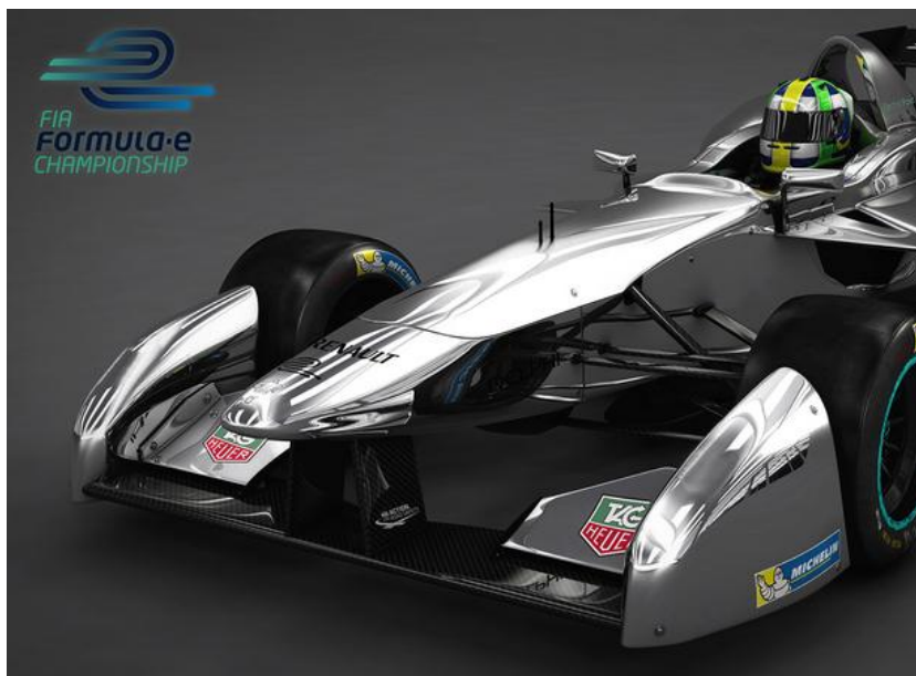
Il·lustració 5.1. Aleró d'avanter d'un Formula E
