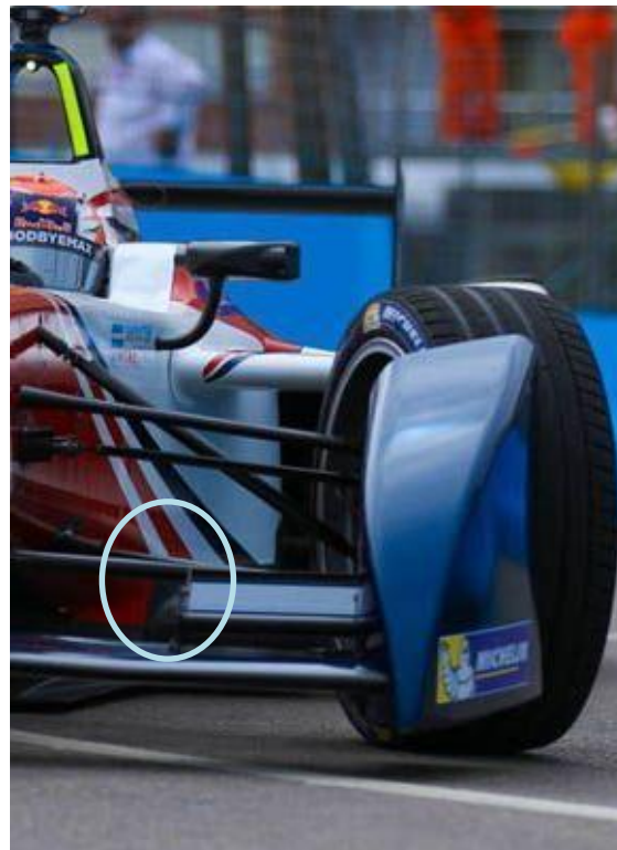
Il·lustració 5.3. Generadors de Vòrtexs d'un Formula E
