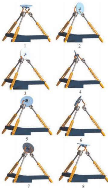
Fig. 4.2. Distintas soluciones al problema cinemático directo
