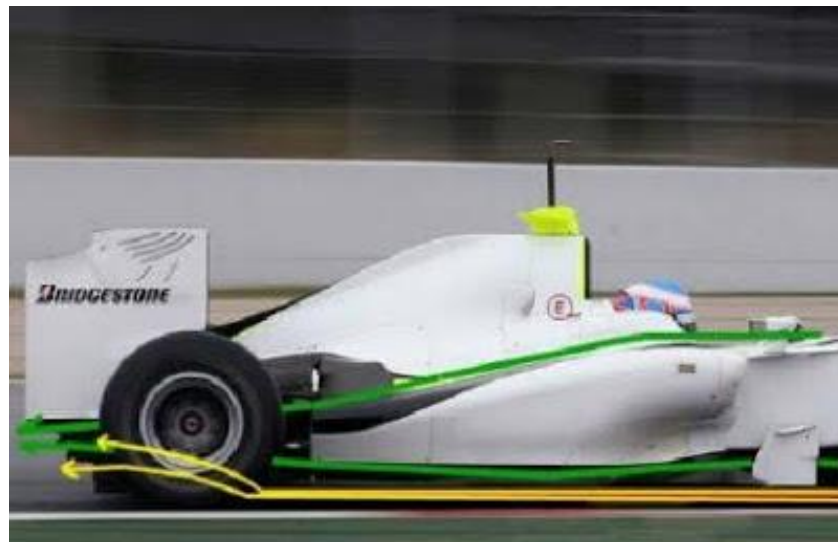
Figura 14. En verd el flux aprofitat per la part superior del monoplaça, en groc el que prové de sota del monoplaça.[21]
