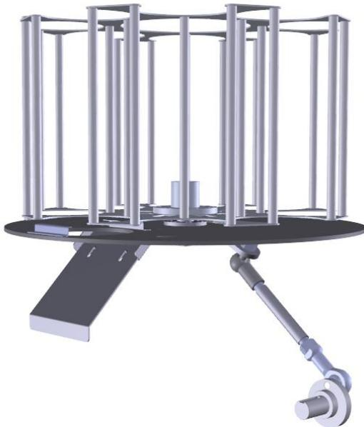
En la Figura 6-2 se muestra el conjunto que permite realizar la carga de platos en el brazo de lanzamiento.
