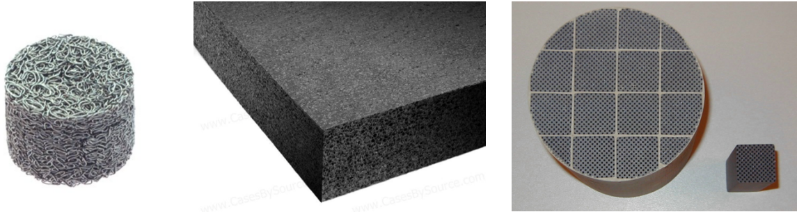
Figura 9 De izquierda a derecha, una gasa metálica, espuma de celdas abiertas y un monolito
