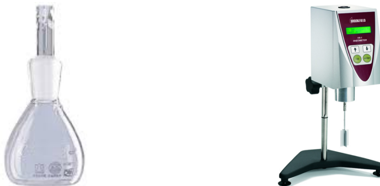
Fig 7.14. A l'esquerra, picnòmetre. A la dreta, reòmetre.
